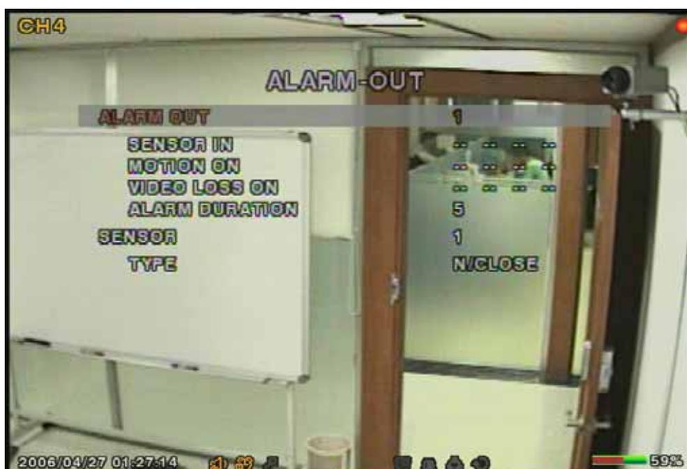
Figure 3.4.2. Alarm-out setup screen
